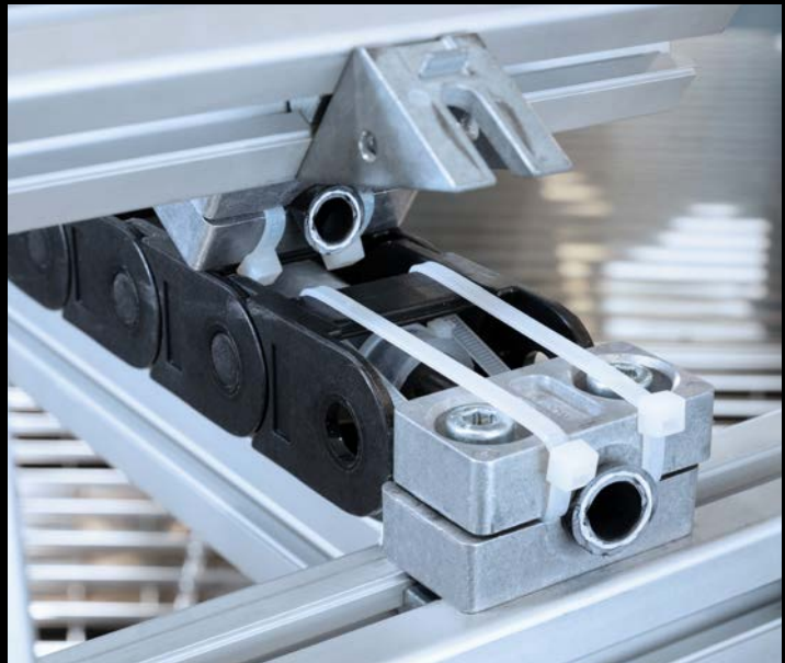
Um den Schlauch während der Bewegung zu stabilisieren, ist der Schlauch in einer Schleppkette gelaufen, die auf der Innenseite mit Silikonband ausgekleidet war.
